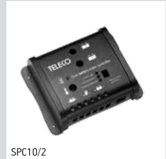
Régulateur de charge PWM 10A /12 – 24 Volt pour 2 batteries indépendantes avec possibilité de sélection du pourcentage de recharge et compensation de température. Protection contre les surcharges, les courts-circuits, l'inversion de polarité. Indiqué pour batteries au plomb avec technologie Liquide, Gel ou AGM.
