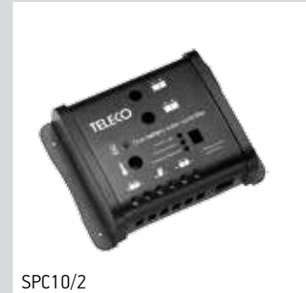
PWM laadregelaar 10 A/12 – 24 Volt voor 2 gescheiden accu's met instelbare laadpercentages met temperatuurcompensator. Beveiligd tegen: overlading, kortsluiting, ompoling. Geschikt voor loodaccu's met vloeibare technologie, gelaccu's of AGM accu's.
