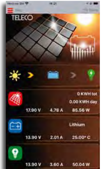
TELECO-App mit Alarmbenachrichtigung bei niedrigem Batteriestand, kompatibel mit MPPT 20 1/B und 30/1B
