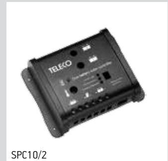
Laderegler 10 A/12 Volt für 2 Batterie Laderegler PWM 10 A /12 – 24 Volt für 2 unabhängige Batterien mit auswählbarem Ladeprozentsatz mit Temperaturtrimmer. Schutz gegen: Überlastung, Kurzschluss, Verpolung. Geeignet für Bleibatterien mit Flüssig-, Gel- oder AGM-Technologie.
