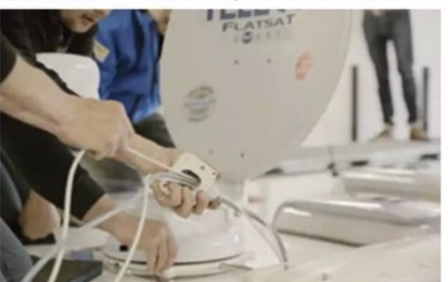
7 ... für die Kabel. Diese werden durch ein spezielles Durchführgehäuse gefädelt.
