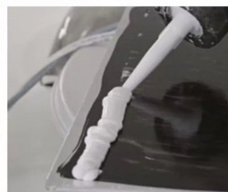
3 Danach kommt der Kleber in Raupenbahnen auf den Metallfuß.
