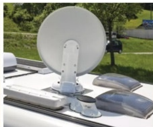
Im Vordergrund mit schwarzer Kappe: die Antenne des Phone-Boosters, der schwache Netzsignale verstärkt.
